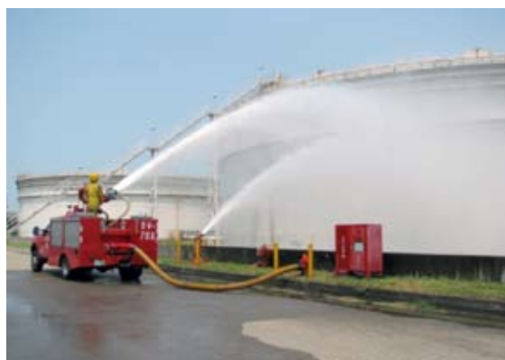
台塑石化公司大型儲槽洩漏應變演練，模擬強烈地震導致13萬噸油槽破裂引燃造成重大火災。廠區消防隊立即佈署10,000GPM大流量砲塔及12英吋水帶車進行水線佈置連結，出水保護鄰近油槽，避免火勢波及蔓延。
