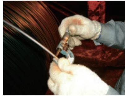
圖十 量測直徑與真圓度
