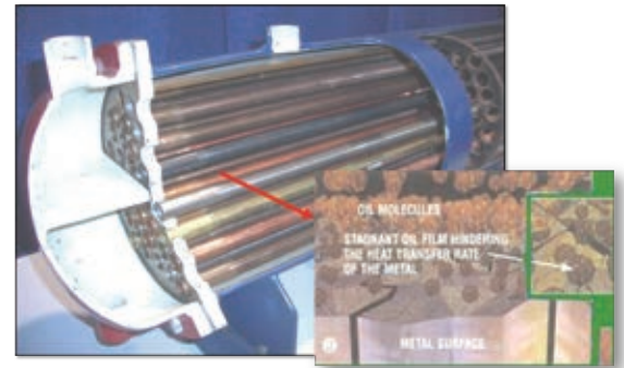
系統運轉後熱交換器剖面圖
