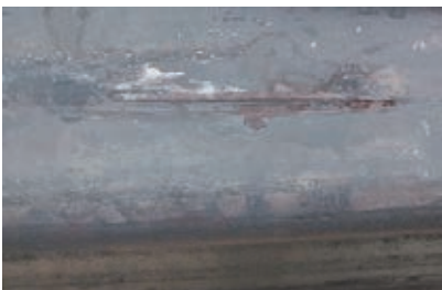
圖九 小鋼胚表面刮傷缺陷
